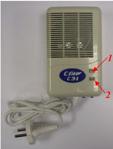
Рисунок 1. Сигнализатор СЗ-1. Вид на переднюю панель. 1-светодиодный индикатор 1 2- светодиодный индикатор 2
