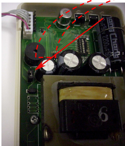
Рисунок 10. Сигнализатор СЗ-1. Запасная перемычка.
