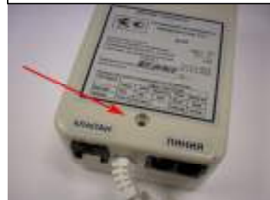
Рисунок 4. Сигнализатор СЗ-2. Крепежный винт удален.
