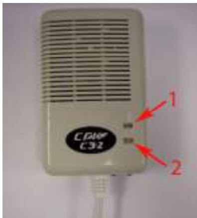
Рисунок 1. Сигнализатор СЗ-2. Вид на переднюю панель. 1-светодиодный индикатор 1 2- светодиодный индикатор 2
