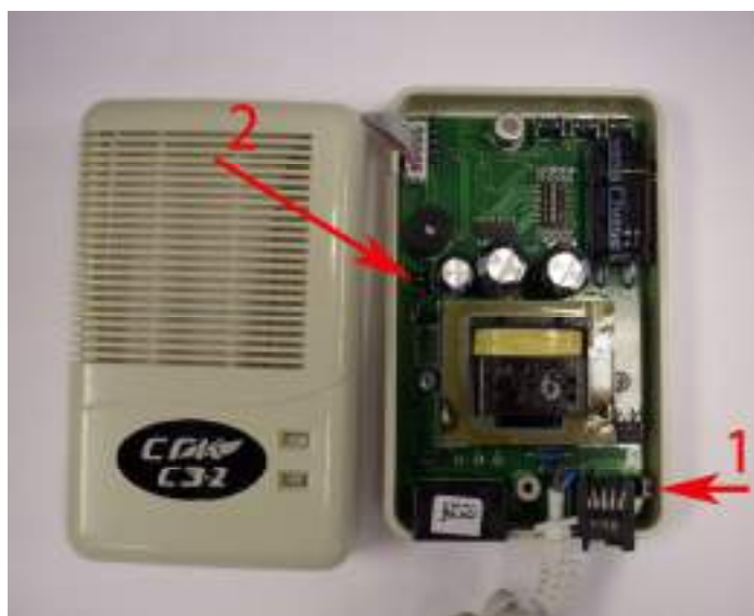
Рисунок 8. Сигнализатор СЗ-2. 1-перемычка, включающая имитатор клапана. 2 – место расположения запасной перемычки
