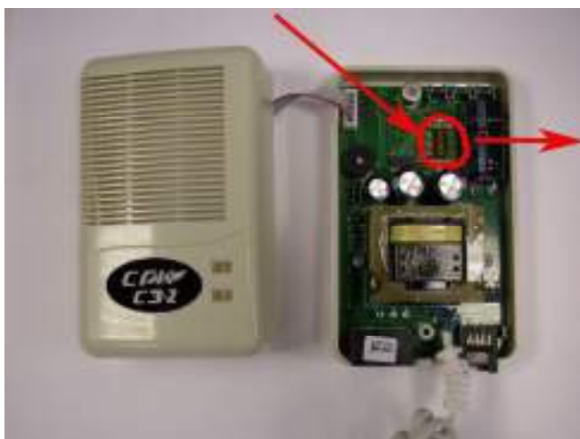
Рисунок 5. Сигнализатор СЗ-2. Вид со снятой передней панелью. Стрелками отмечено расположение микропереключателей адреса
