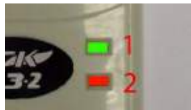
Рисунок 18. Индикаторы сигнализатора СЗ-1. Авария «обрыв клапана».
