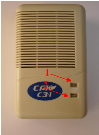
Рисунок 1. Сигнализатор СЗ-Х. Вид на переднюю панель. 1-светодиодный индикатор 1 2- светодиодный индикатор 2
