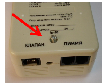
Рисунок 3. Сигнализатор СЗ-Х. Крепежный винт выкручен.
