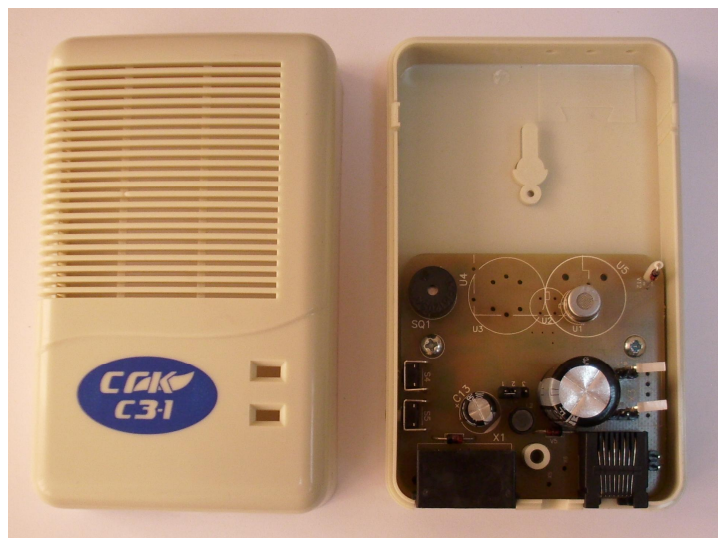
Рисунок 5. Сигнализатор СЗ-Х бытовой серии. Вид со снятой передней панелью.
